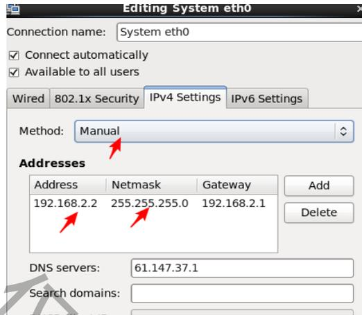
图 7-8 修改 DNS 服务器的 IP 地址
