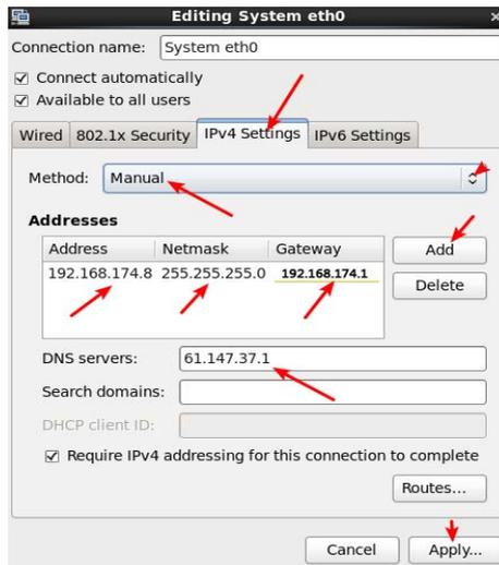
图 6-10 使用图形界面的方式设置 IP 地址
